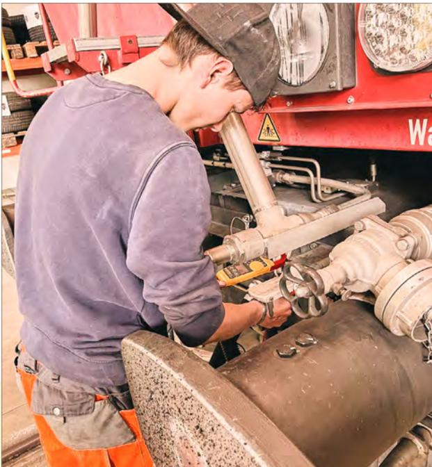
Entnahme einer Ölprobe am Achsgetriebe zur Zustandsanalyse
