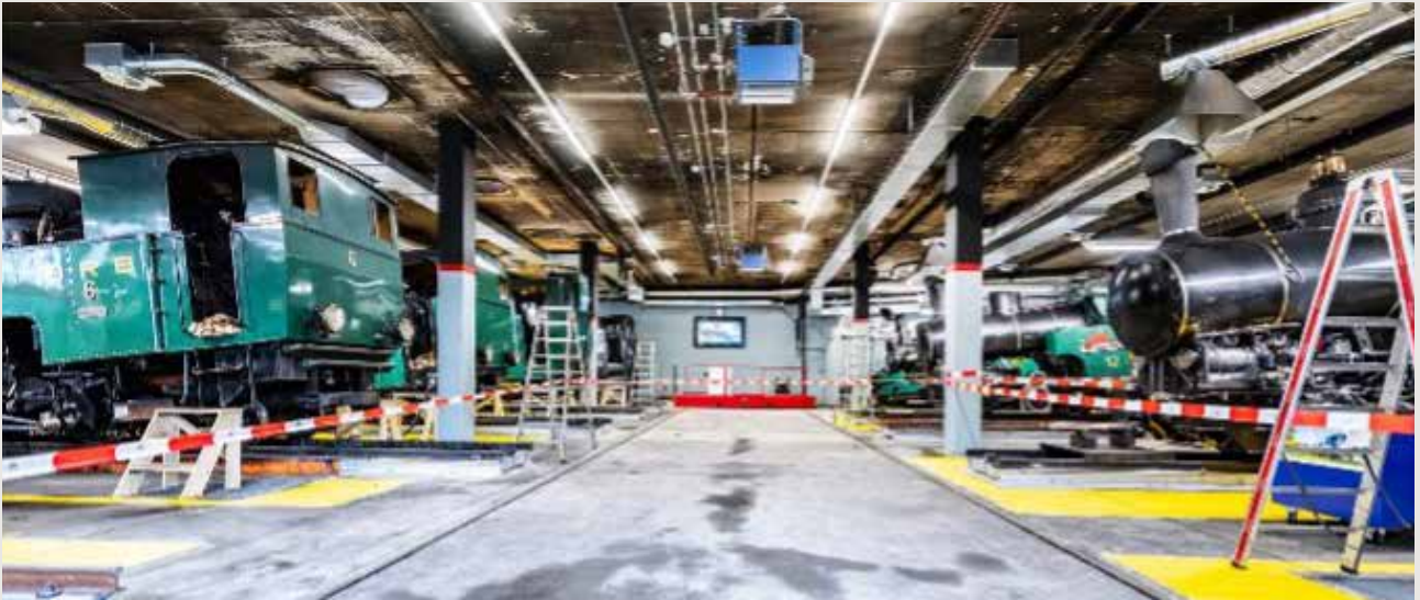
Hinten mittig im Bild: die rote Schiebebühne von Windhoff verfügt über eine Tragkraft von 20 Tonnen.
